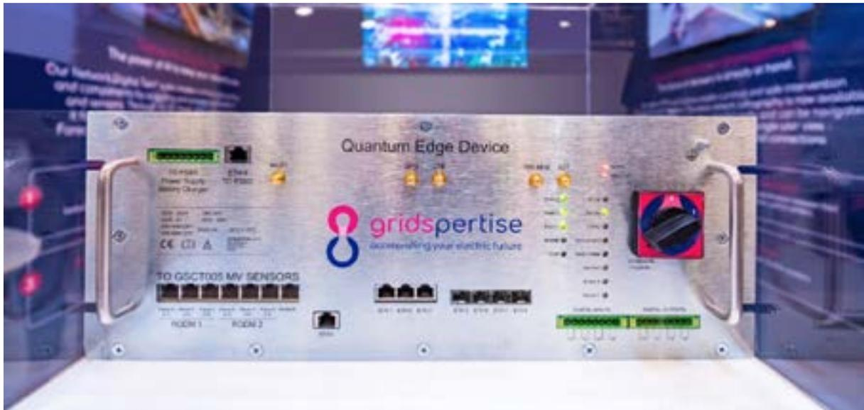
un unico dispositivo che sostituirà dispositivi quali la RTU, l'RGDM, il router ed il Concentratore e prevederà tutte le loro funzionalità, con la possibilità di ulteriori sviluppi.
